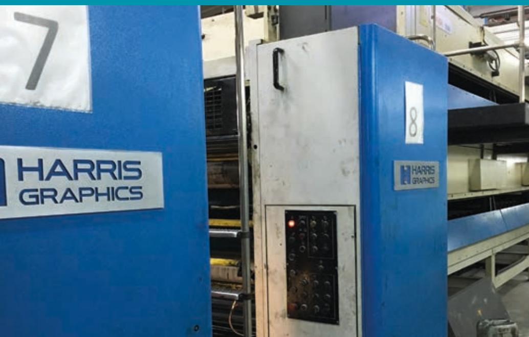
海德堡哈里斯M-300热固型印刷机，GPS印刷出版及发行公司
