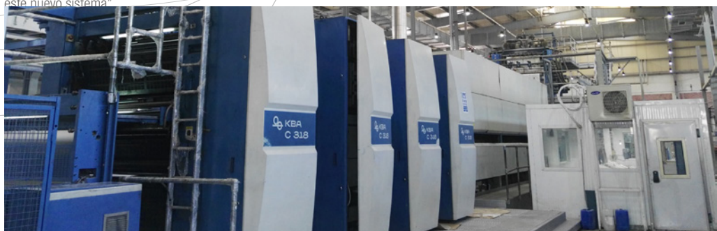
KBA Compacta 318 sobre la cual están instalados los sistemas QIPC.
